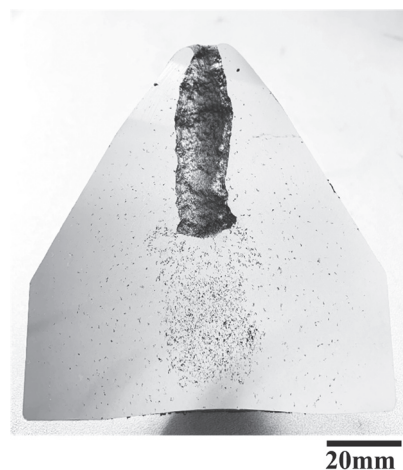
Fig. 10 Cross section of a Tatur mold without Sr alloy. Sr無添加合金のテーターモールド断面。
