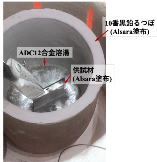
Fig. 2 供試材を 720°C の ADC12 合金溶湯に 5 秒間浸漬した.
