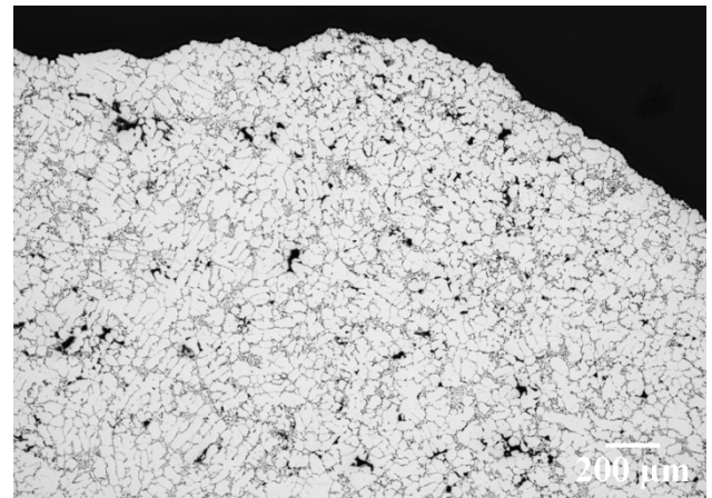
図8 ダマの表面部の観察結果。多量の酸化皮膜が観察されました。
