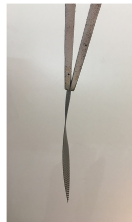
図13 ヤットコは先端の形状が重要で、「網八」をしっかりと掴めることが要求されます。
