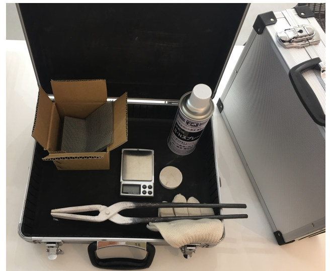
図12 「網八」セット。ヤットコ、重量計、耐熱材、BNスプレー、軍手が付いています。
