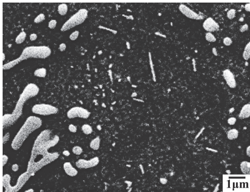
Fig. 11 SEM image of deep etched Al-8%Si alloy (heat treatment: 400°C × 120 min.). 深腐食した Al-8%Si合金の SEM像 (熱処理: 400°C×120分間).
