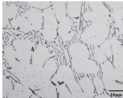
Fig. 4 OM image of Al-8%Si alloy (without air gap). Al-8%Si合金のマイクロ組織(エアギャップ無し)。
